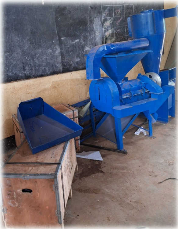
Concasseur (1 encore en boîte) et construction de l'atelier pour les concasseurs École secondaire d'Endallah
